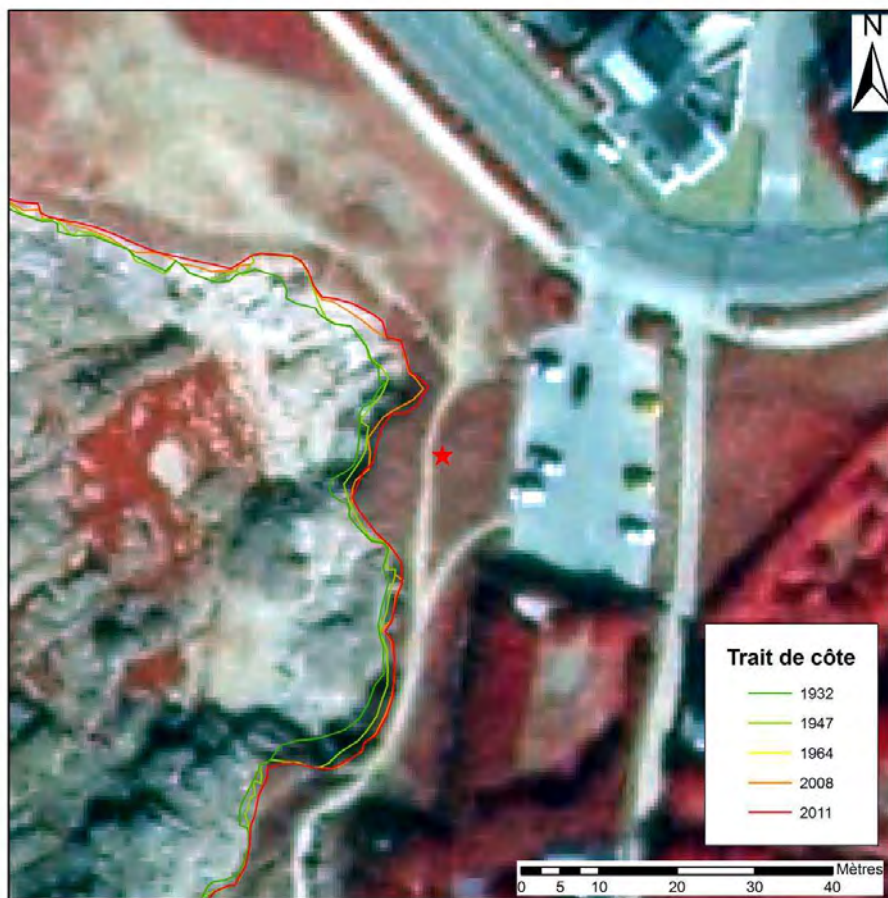
Figure 1.9. Recul du trait de côte au cours du temps sur le fonds IGN (DAO et traitement : C. Netter).
