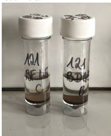
Document 5 : Exemple de tube préparé pour les mesures de pH.
