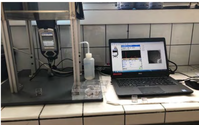
Document 12 : Photographie de l'installation pour la spectrométrie de fluorescence X.
