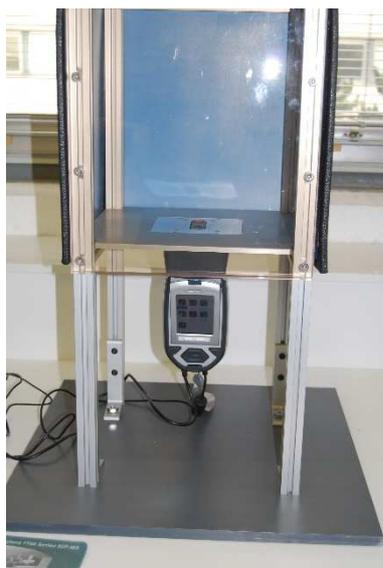
*Spectromètre de fluorescence X*
